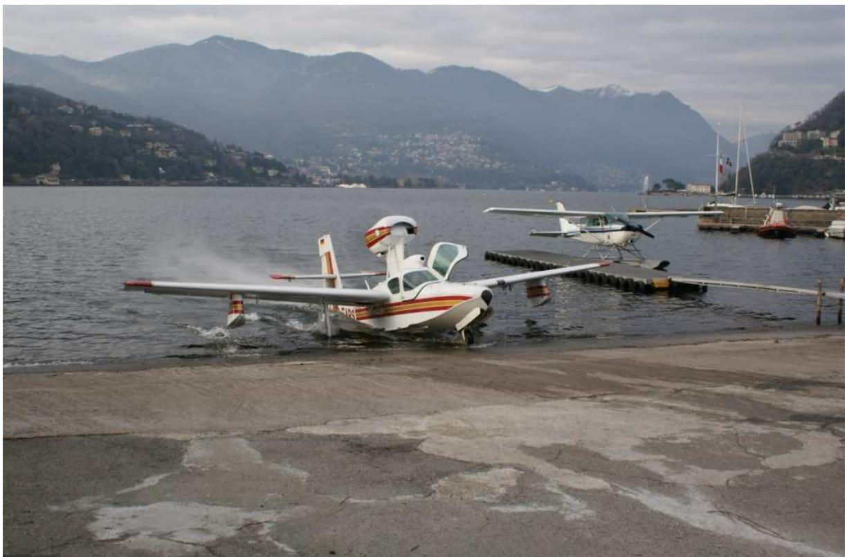
Mit ausgefahrenem Einziehfahrwerk rollt man auch mit diesem Amphibium mit viel Leistung, aber ohne fremde Hilfe die Rampe Richtung Hangar hinauf
