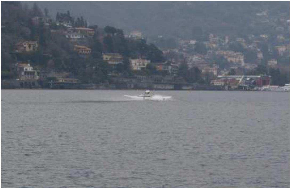
Der Startvorgang ist bereits bei leichtem Wellengang sehr anspruchsvoll, weil das Flugzeug hier stark zum sogenannten „Porpoising“, dem longitudinalen Aufschaukeln, neigt
