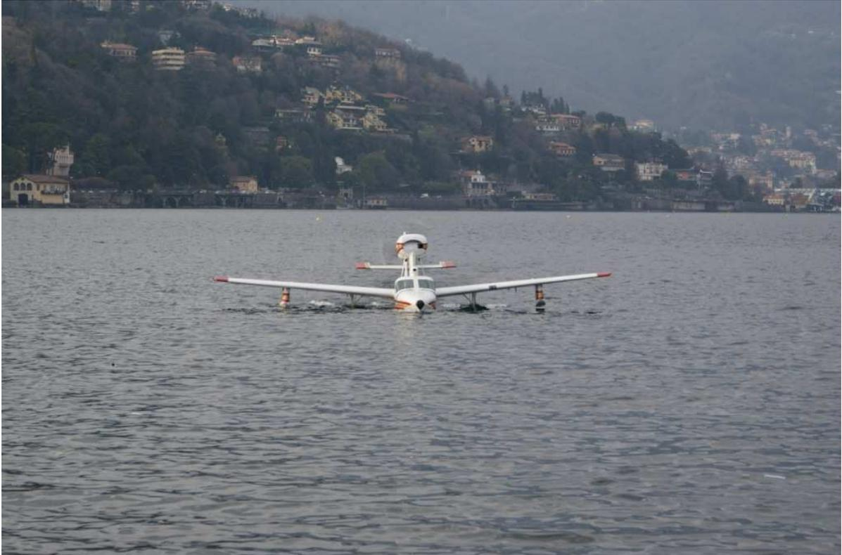
Dieses sogenannte Flugboot besitzt keine anstelle eines Fahrwerks installierten Schwimmer, denn der Rumpf dient als Schwimmkörper. Die sich daraus ergebende Perspektive macht ein Wassermanöver in diesem Flugzeug zu einem besonderen Erlebnis.
