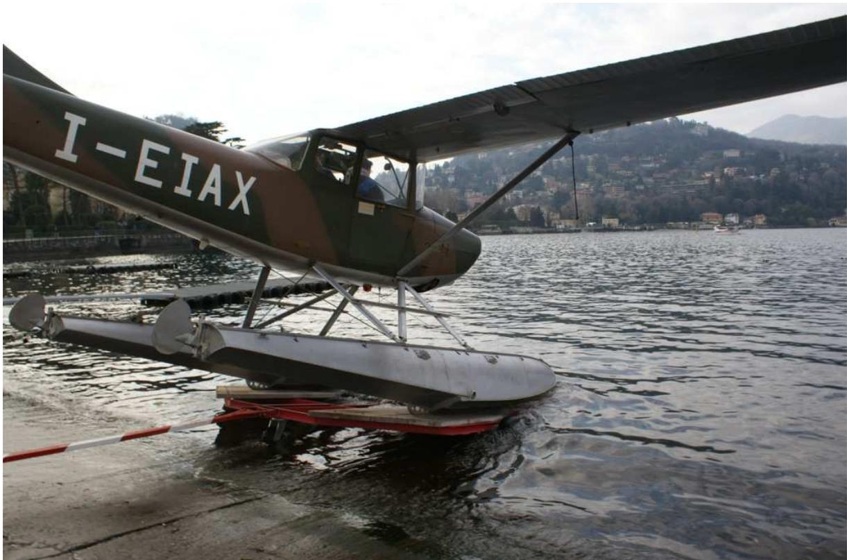
Mit drehendem Propeller wird das Flugzeug auf der Pritsche mit einem Traktor entlang der Rampe ins Wasser gelassen
